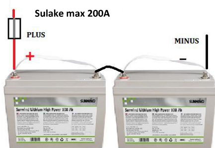
2KPL AKKUA SARJAANKYTKENTÄ 24V
