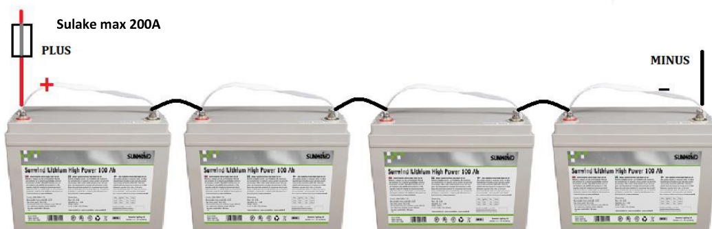
4KPL AKKUA SARJAANKYTKENTÄ 48V
